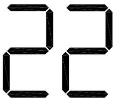
LED дисплей прихованого типу, коли кондиціонер вмикають (за умови коли не вимкнено дисплей з пульта керування)-відображає температуру, яку обрано користувачем (в даному випадку 22 °С). Також, коли вбудована функція самодіагностики індексує помилку, то на дисплей виводиться цифровий код помилки у вигляді букви та літери. Також це табло показує таймер в годинах вмикання/вимикання приладу в залежності від обраної функції.
