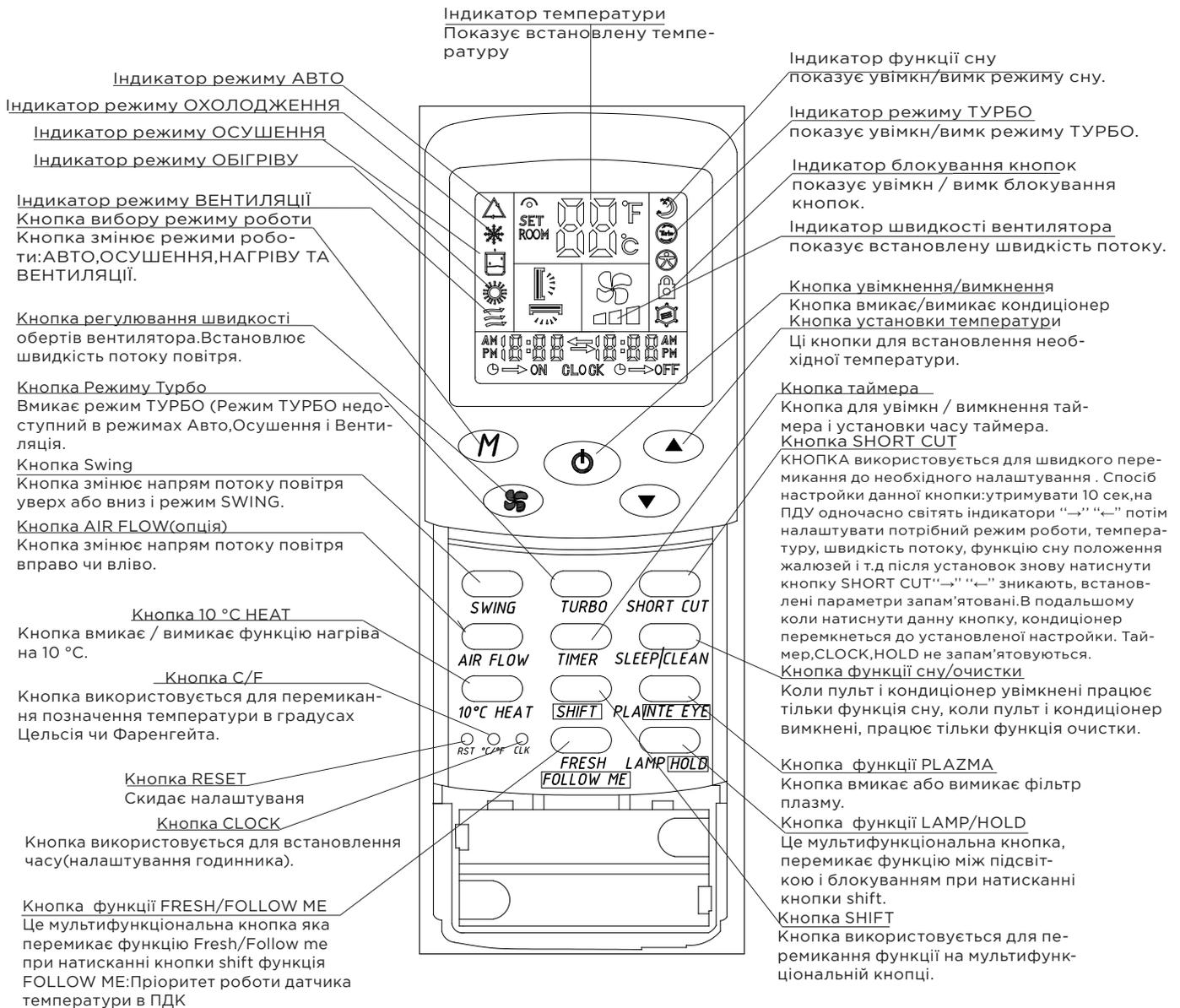
**ПРИМІТКА:** У режимі Турбо зміна температур відбувається швидше і амплітуда регулювання вище, якщо ви відчуваєте, що температура кімнати занадто прохолодна або занадто спекотна, вимкніть режим Турбо.
