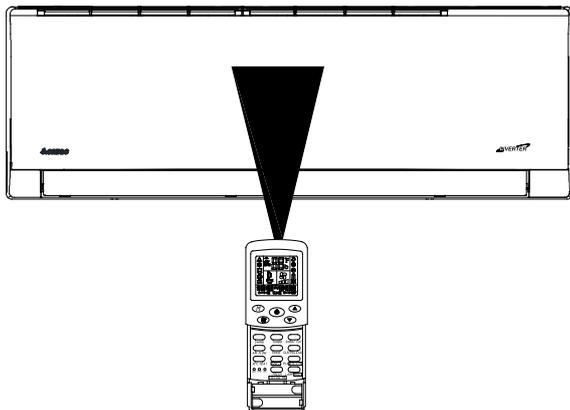
Натискання на кожен кнопку ПДУ запускає процес відсилання сигналу на внутрішній пристрій кондиціонера. У свою чергу, отримавши нову команду від ПДУ кондиціонер посилає сигнал назад. При вдалій відправці сигналу і отримання підтвердження лунає звуковий сигнал, що підтверджує нову команду. На пульті керування блимає індикатор
